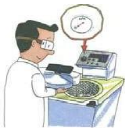
压力恢复正常方可开启
